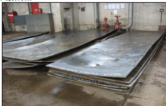
Полученные сваркой взрывом двухслойные листы (средний размер – 8 м 2 )
