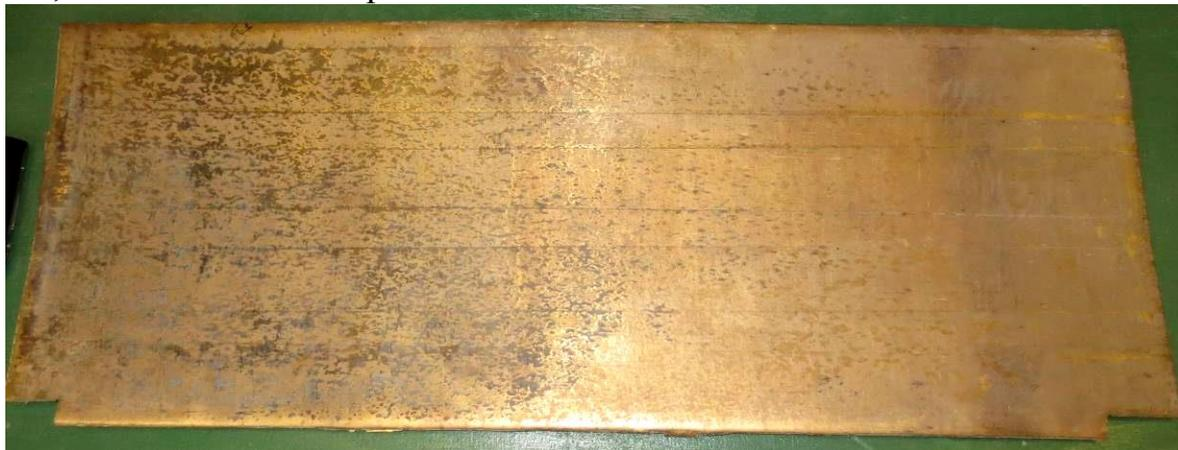
Рис. 1. Лист термометалла 36Н+Л63 размером 6х300х800 мм.
