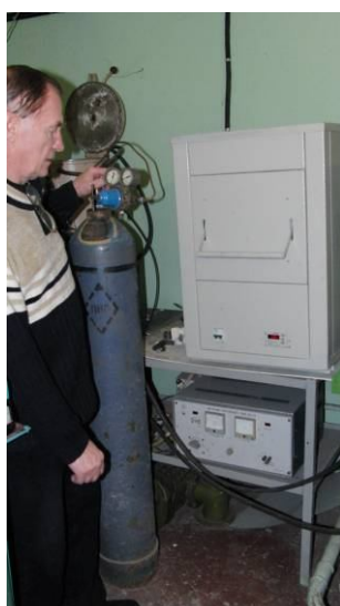
Высокотемпературный вакуумный стенд для спекания пористых материалов Печь СНОЛ 2.3.2/16 до 1650°C Компьютеризированный пульт управления РНТО-190-250
