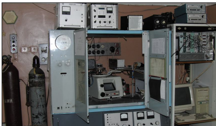
Динамическая рентгенография Синхронизация дифракционной, температурной и видеорегистрации
