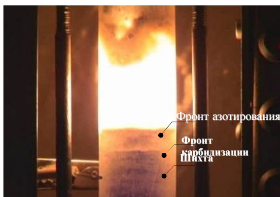
Фотография процесса горения Ti+0,5C в потоке азота
