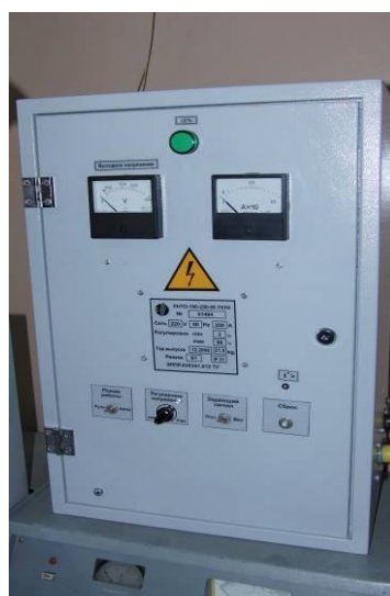
Высокотемпературный вакуумный стенд для спекания пористых материалов Печь СНОЛ 2.3.2/16 до 1650°C Компьютеризированный пульт управления РНТО-190-250
