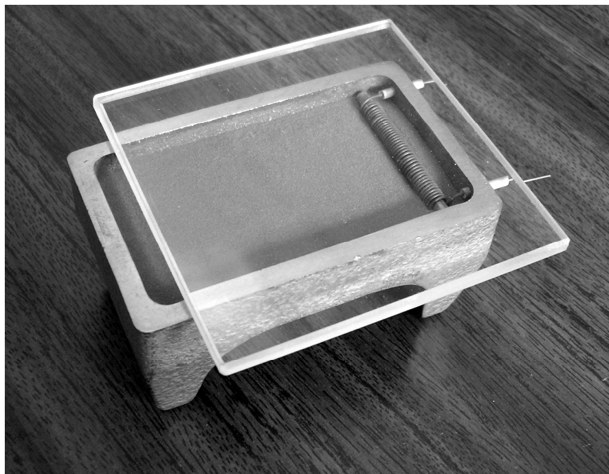
Рис. 1. Ванночка для экспериментального исследования фильтрационного горения плоского слоя порошкообразного реагента.
