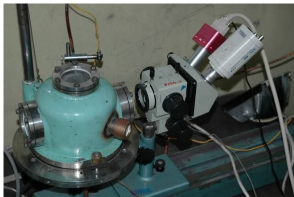
Скоростные видеокамеры (50-36000 кадров/сек) Высокоскоростная электронно-оптическая камера K008M Скоростная камера (Foton Focus)
