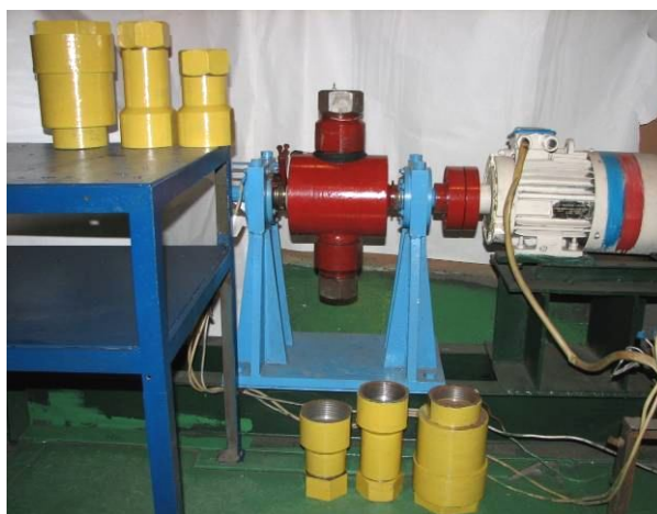
Опытно-промышленные центробежные установки Ускорение - до 1000 g, рабочая загрузка – до 6 кг
