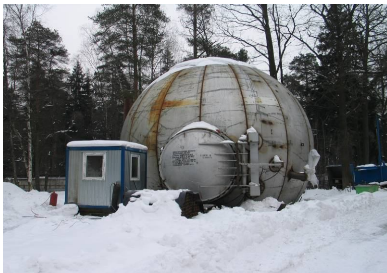
Бронекамера для производства подрывов зарядов ВВ большой массы
