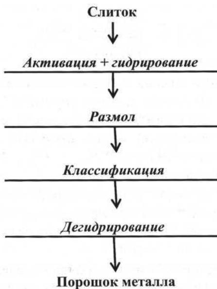
Рис. 4.1.4. Принципиальная схема ГСПП
