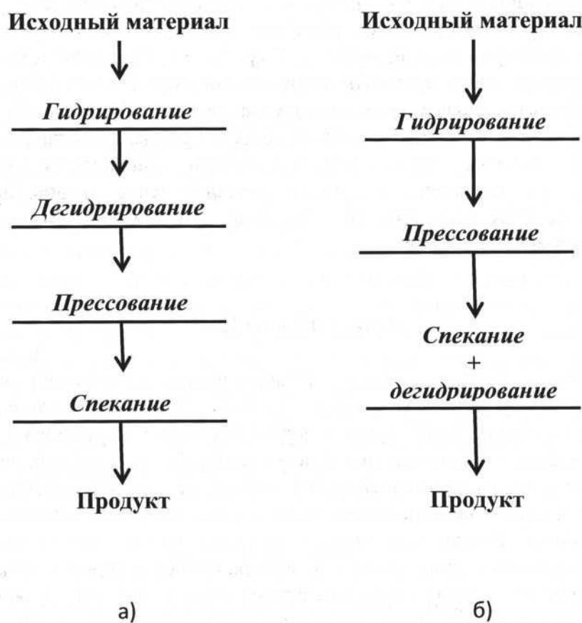
**Рис. 4.4.2.** Две технологии для получения порошков сплавов гидридным методом:
