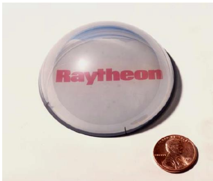
Рисунок 1 – Обтекатель из прозрачного нелегированного Y_2O_3 [3]
