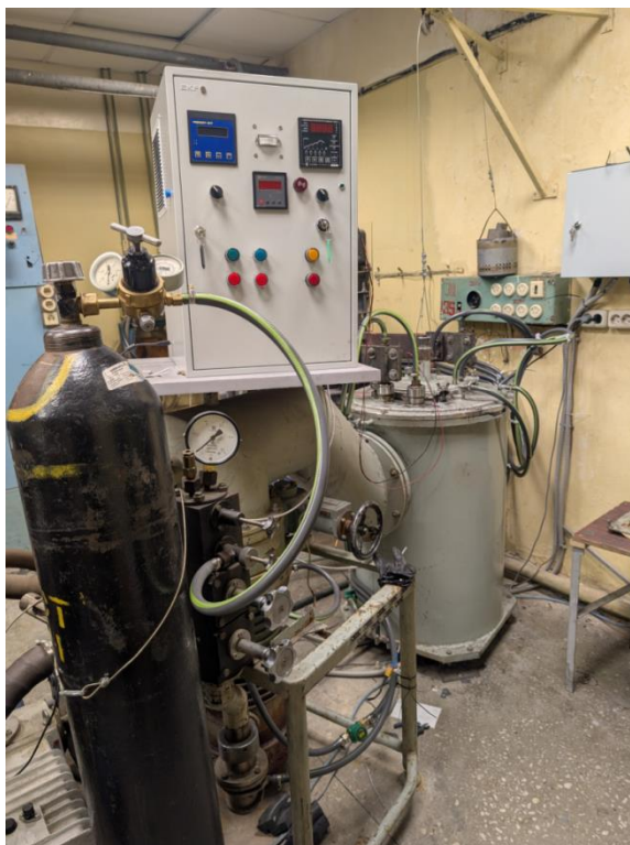
Рисунок 9 – Высокотемпературная печь для спекания керамики
