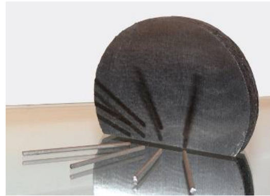
Рис.11. Внешний вид дисковых и стержневых литых СВС-электродов для ЭИЛ
