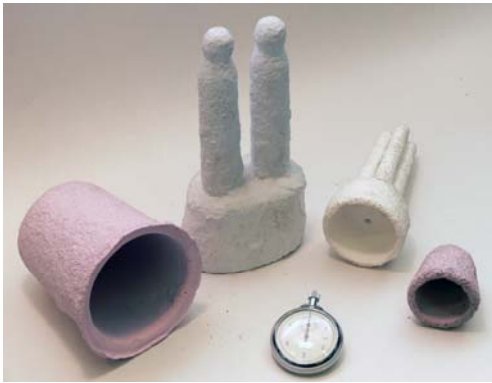
Рис.10. Внешний вид керамических форм для получения стержневых электродов в режиме СВС
