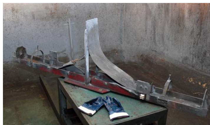
Рис.12. Общий вид опытно-промышленной центробежной СВС-установки
