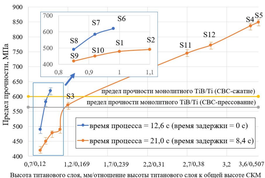
Рисунок 64 – Зависимость предела прочности на изгиб от времени задержки и высоты титанового слоя
