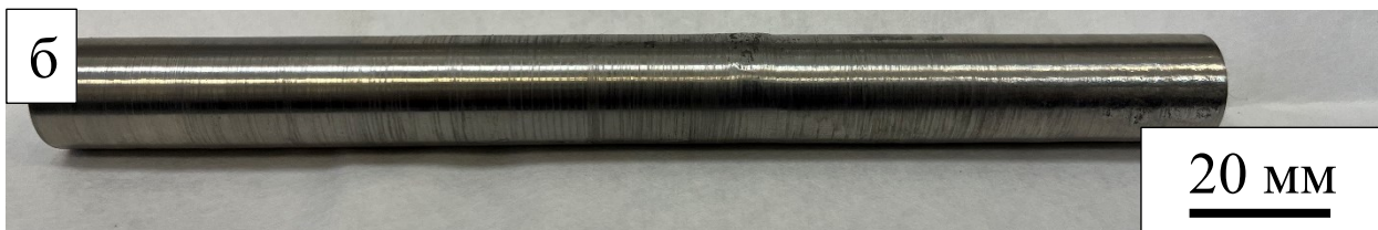
Рисунок 7 – Исходный прутки титана: (а) ВТ1-0 и (б) ВТ6, используемый для получения титановой стружки
