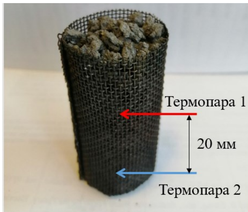
Рисунок 14 – Схематическое расположение термопар в засыпке из титановой губки перед СВС-гидрированием
