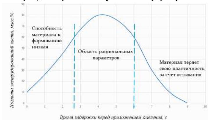
Рисунок 3 – Характерная зависимость полноты экструдированной части от времени задержки перед приложением давления
