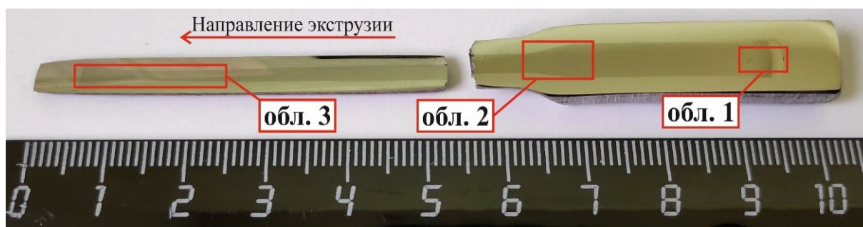
Рисунок 3.14 – Образец, полученный неполной экструзией стальной ампулы с порошковой смесью Ni-Al
