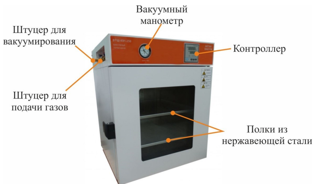
Рисунок 2.2 – Вакуумный термошкаф АКТАН ВТШ-К24-250
