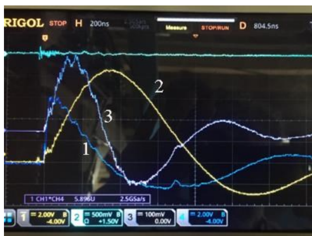
Рисунок 19 – Осциллограмма искрового разряда. 1 - U(t) ; 2 - I(t) ; 3 - P(t)
