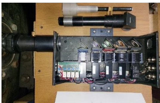
Рисунок 4 – Фотография и оптическая схема пирометра.
