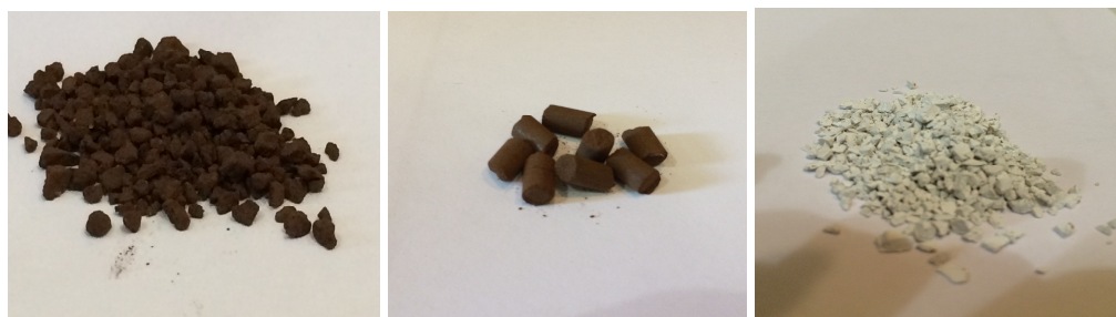
Рисунок 2. Гранулы и таблетки: шлам комбината «Северсталь» 90%+глина 10%, гранулы: ZnO 90%+глина 10%
