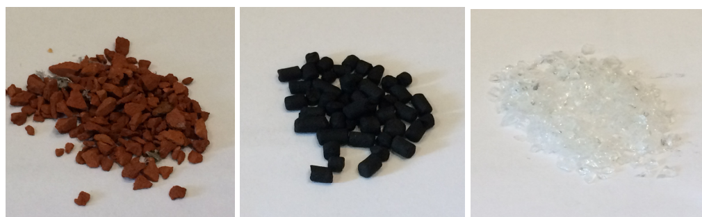
Рисунок 3. Шамотный кирпич, уголь АГ-3, кварцевая крошка (1,3-2,5 мм)
