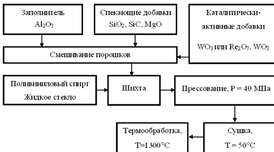
Рисунок 21 – Технологическая схема получения пористого каталитического конвертера методом смешения
