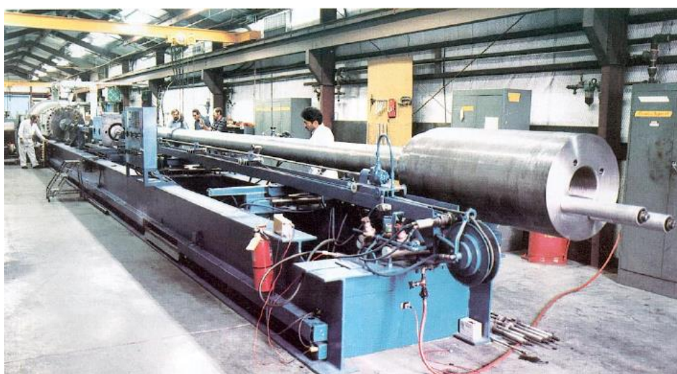
Рисунок 1.7 – Двухступенчатая легкогазовая пушка для экспериментов с ударными волнами в Лаборатории Сандиа (США) [26]
