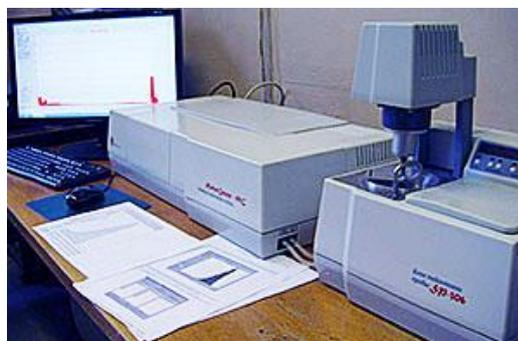
Рисунок 2.1 – Анализатора размера частиц «Микросайзер - 201С»
