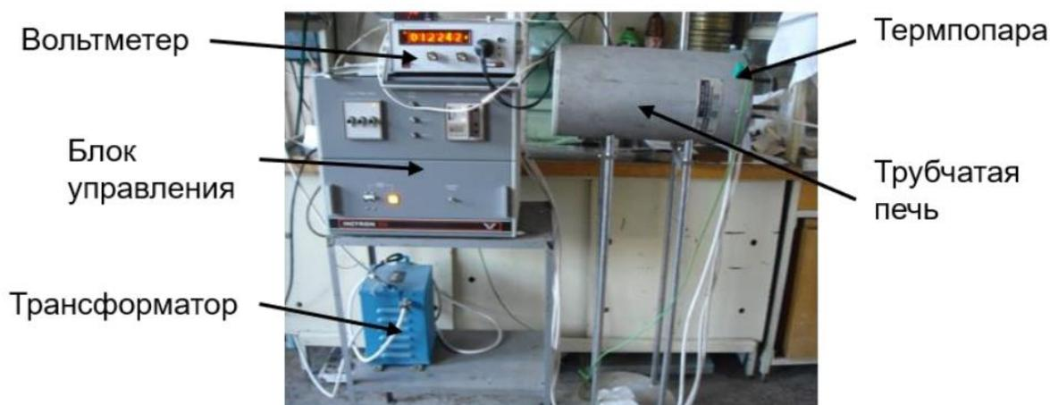
Рисунок 2.2 – Экспериментальная установка для проведения СВС-экспериментов в трубчатой печи с программируемым нагревом
