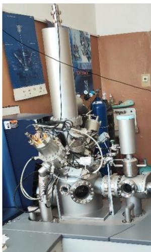
Рисунок 2.12 – Общий вид установки для проведения время пролётной масс-спектрометрии (TOF-SIMS)
