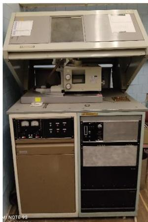
Рисунок 2.4 – Внешний вид установки автоматизированного рентгеновского дифрактометра ДРОН-3М
