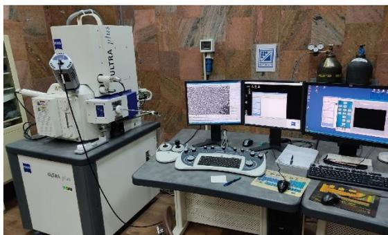
Рисунок 2.5 – Фотография микроскопа Carl Zeiss Ultra plus на базе Ultra 55
