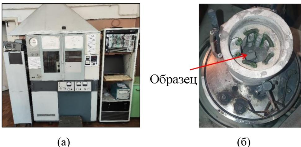
Рисунок 2.11 – (а)-общий вид установки для проведения время разрешающей рентгеновской дифракции (TRXRD), (б)-внутренний вид печи
