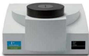
Рисунок 2.13 – Дифференциально-термический анализ DTA PT 1600
