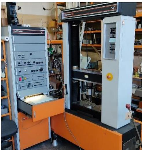
Рисунок 2.8 – Напольная испытательная машина INSTRON-1195 для испытаний на прочность при сжатии
