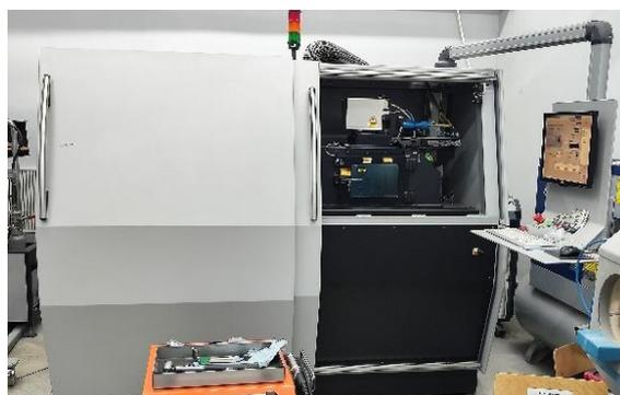
Рисунок 2.14 – 3D принтера Concept Laser M2cusing
