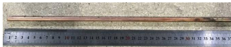
Рисунок 4 — Внешний вид длинномерного стержня из сплава \text{Cu}_{70}\text{Fe}_{30} , полученного из переплавленной СВС-заготовки
