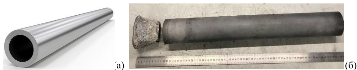
Рисунок 16 — Внешний вид трубчатой оболочки-кристаллизатора ( \delta = 6 мм) до разливки (а) и отлитого слоевого электрода (б)
