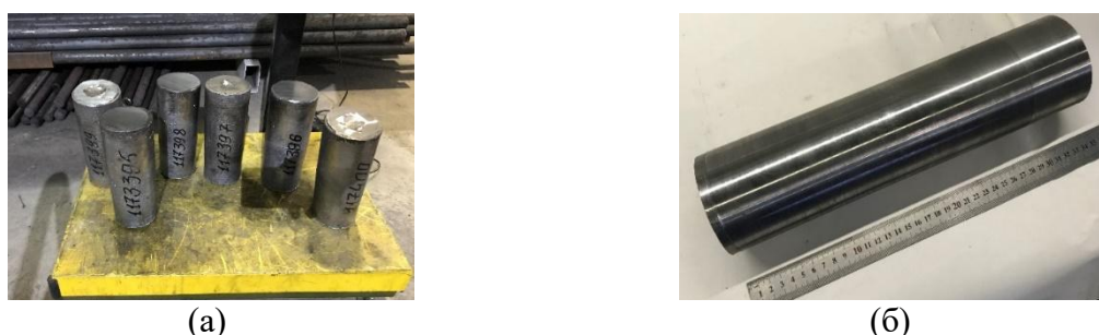
Рисунок 9 — Внешний вид партии ЛПЗ после ВИП (а) и ЛПЗ после мехобработки (б)
