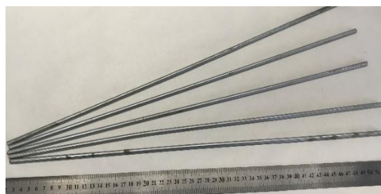
Рисунок 11 — Внешний вид электродов, вытянутых из расплава ХТН-61Ц (Ø 3мм)
