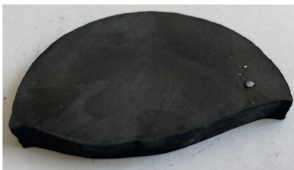
Рисунок 47 – Фотография образца Ti_{1-x}Zr_xC после баротермического уплотнения
