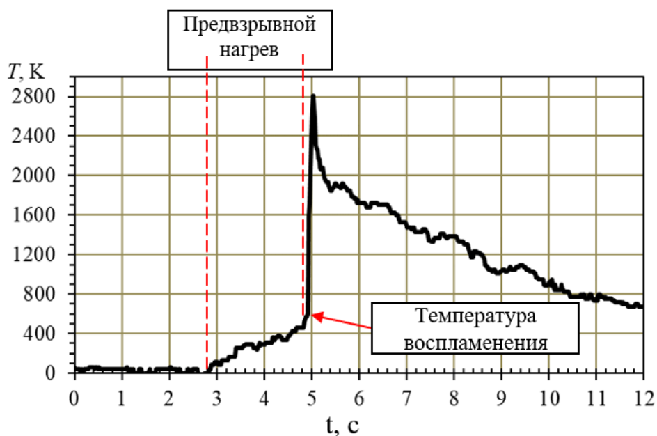
Рисунок 29 – Типичная термограмма механически активированной в течение 5 минут смеси (Ti+Zr+C)
