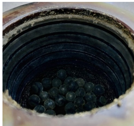
Рисунок 2 – Продукты механообработки шихты Li–Ti на стенках размольного стакана
