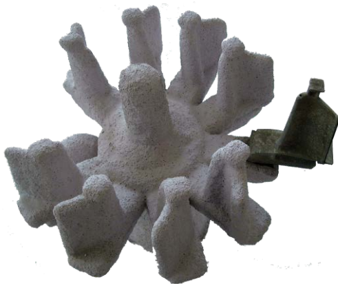
Рис. 8. Фотография литейной формы из "Рубина-2" для литья рабочих лопаток газотурбинных двигателей.
