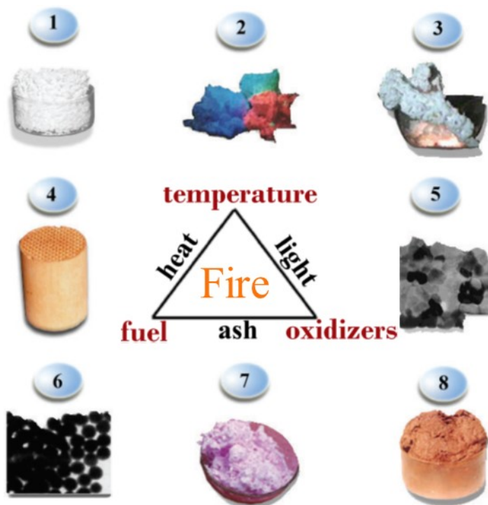
Рисунок 1.13 – Огонь и его важные составляющие - тепло, свет и зола, для синтеза материалов: 1) \text{SrAl}_2\text{O}_4 , 2) редкоземельные люминофоры, 3) диоксид циркония, 4) сотовый монолит с покрытием \text{Pd/CeO}_2 , 5) ПЭМ диоксида циркония, 6) ПЭМ цирконата-титаната свинца, 7) розовый пигмент ( \text{Co/Mg}_2\text{B}_2\text{O}_5 ), 8) \text{NiFe}_2\text{O}_4 [14]
