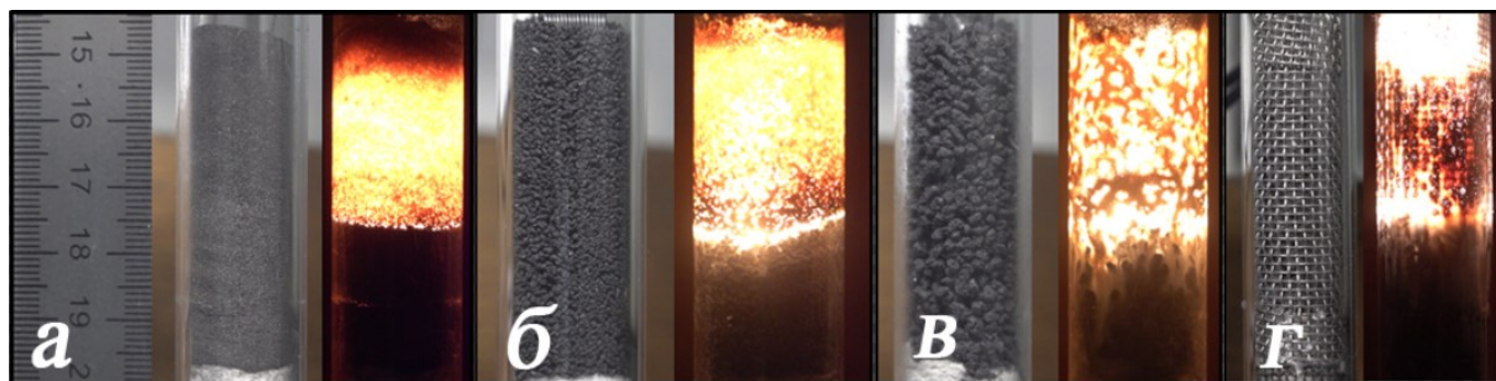
Рисунок 2 – Внешний вид исходной шихты и кадры горения состава (1-X)(\text{Ti}+\text{C})+X(\text{Ti}+2\text{B}) с X = 0.6 : а – порошковая смесь; б и в – гранулированные смеси D_{0.6} и D_{1.7} ; г – гранулированная смесь внутри вставки из металлической сетки
