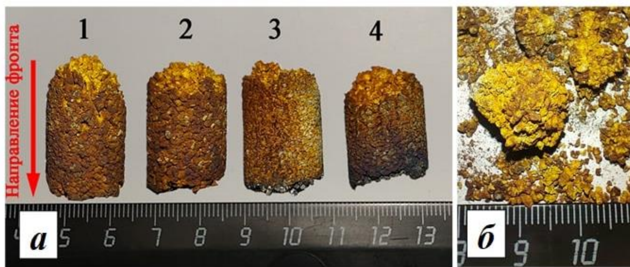
Рисунок 36 – Внешний вид продуктов синтеза Zr+0.5C в потоке азота: 1 – 700 л/ч, 2 – 1000 л/ч, 3 – 1500 л/ч, 4 – 1700 л/ч (а); излом образца Zr+0.5C при Q = 1000 л/ч (б)
