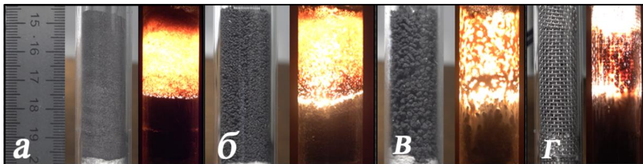
Рисунок 14 – Внешний вид исходной шихты и кадры горения состава (1-X)(\text{Ti}+\text{C})+X(\text{Ti}+2\text{B}) с X = 0.6 : а – порошковая смесь; б и в – гранулированные смеси D_{0.6} и D_{1.7} ; г – гранулированная смесь во вставке из металлической сетки
