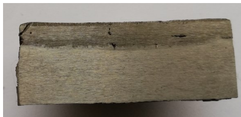
Рисунок 19 - Однослойная наплавка, M_1/M_2=100/0 г, a=100 г
