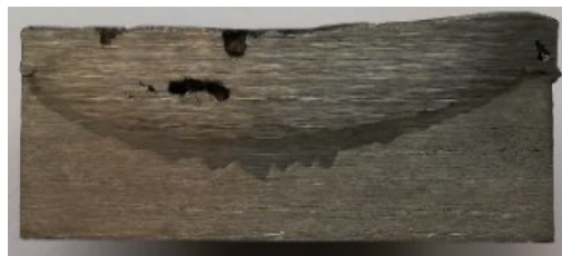
Рисунок 20 - Двухслойная наплавка, M_1/M_2=50/50 г, a=100 г
