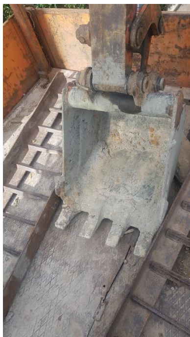
Рисунок 16 – Внешний вид ковша экскаватора (а) и зубьев ковшей с наплавленными СВС-электродами Ti+2Co+0,9V защитными покрытиями (б)
