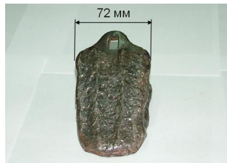
Рисунок 16 – Внешний вид ковша экскаватора (а) и зубьев ковшей с наплавленными СВС-электродами Ti+2Co+0,9V защитными покрытиями (б)
