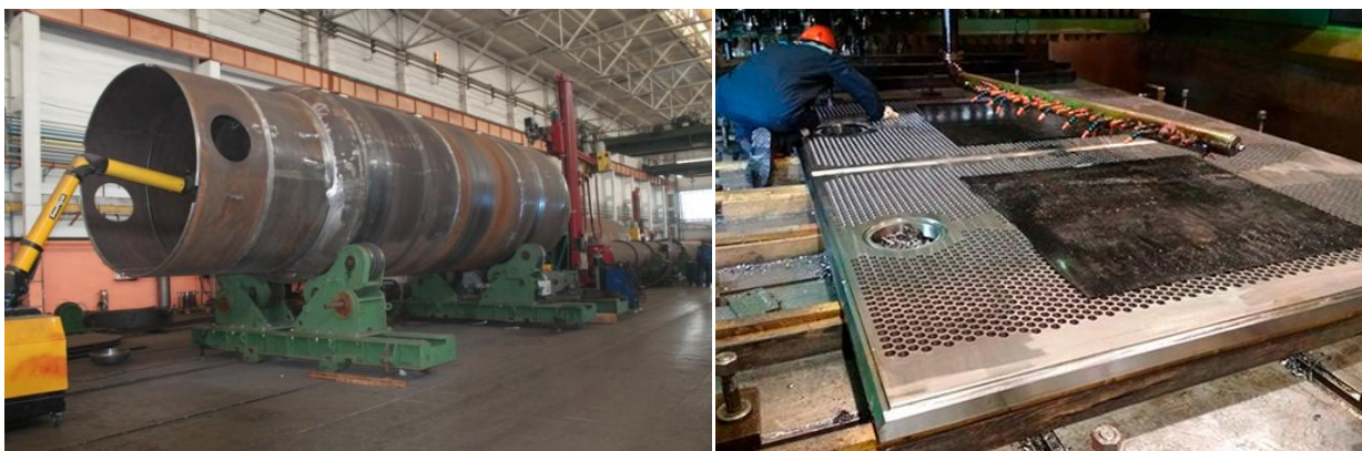
Рис.9. Применение крупногабаритного биметалла, произведенного по разработанным технологиям в изделии. а - процесс изготовления корпуса САОЗ из биметалла 22К+08Х18Н10Т, размером 60(55+5)х2500х9900 мм; б - трубная решётка конденсатора АЭС после сверления отверстий из биметалла сталь+титан (09Г2С+ВТ1-0), размером 30(25+5)х3200х3600.
