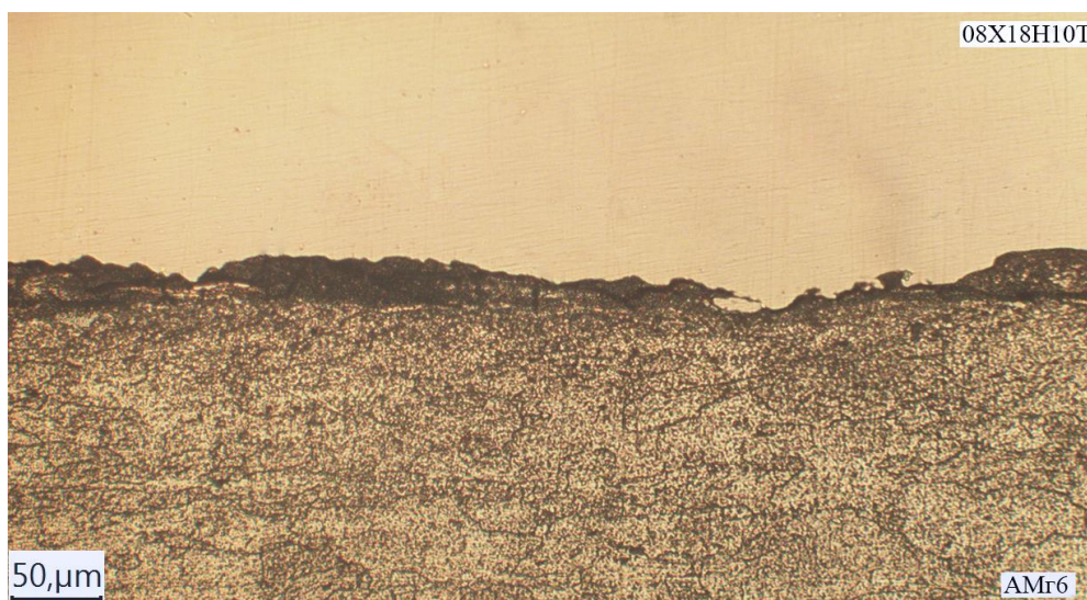
Рис. 6. Граница соединения АМг6-08Х18Н10Т
