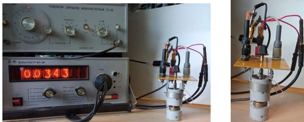
Рис.4. Измерительная ячейка для измерения диэлектрической проницаемости ( \epsilon ) и тангенса угла диэлектрических потерь ( \text{tg}\delta ) непроводящих керамических материалов.
